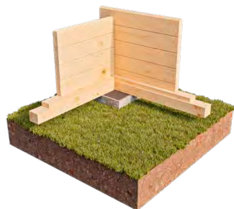
Фундамент из полнотелых цементно-песчаных блоков.
