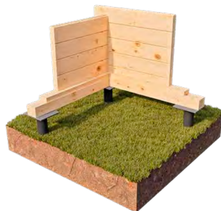
Свайный фундамент с деревянным обвязочным ростверком.
